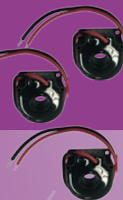
3x cewki mierzące aktualny pobór napięcia
